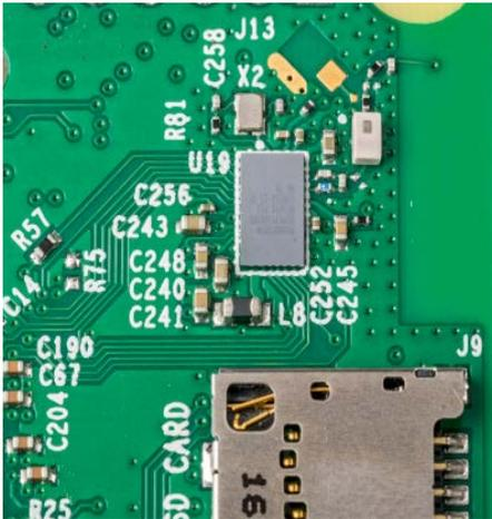
Das Kombimodem eines Raspberry Pis mit Anpassungskomponenten und Bandpass-Filter (weiß). Letzterer lässt sich nur sehr schwer entfernen – meist zerstört man das Modem beim Versuch.
