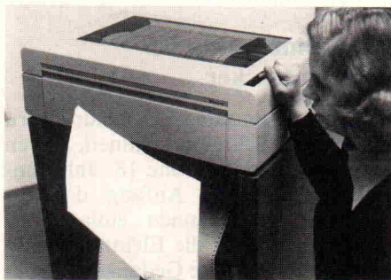
Matrixdrucker mit 9x7-Matrix (Foto: Siemens)
