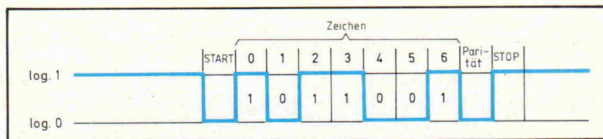
Bild 3. Leitungspiegel beim Senden des Zeichens 'M' (hexa 4D, gerade Parität, 1 STOP-Bit)
