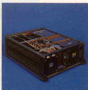
DATA-Generator mit Steckverbinder Serie 57, Flachkabel und -Stecker.
