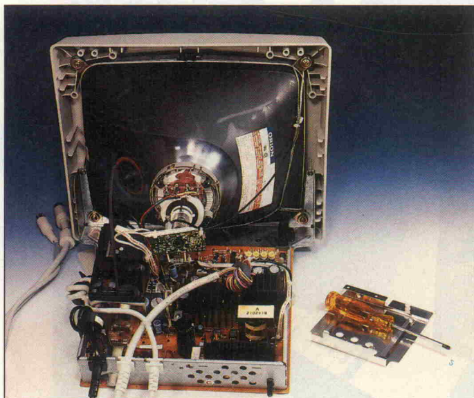
Der Monitor enthält auch das Rechnernetzteil. Unnötigerweise ist er nicht PC-kompatibel.
