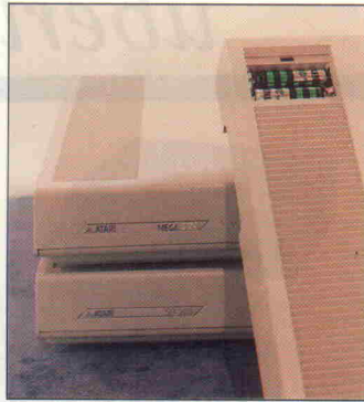
Die neuen Ataris haben eine akku-gepufferte Echtzeituhr. Die Akkus sind von außen zugänglich.
