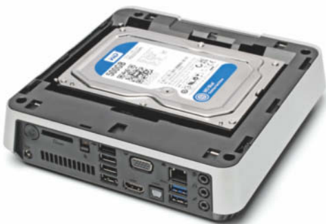
Die 3,5-Zoll-Festplatte des VivoPC lässt sich leicht austauschen.
