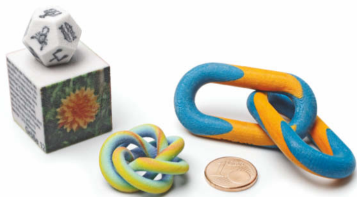
Farbdrucktechniken im Vergleich: Den Würfel und den Dodekaeder links sowie den Regenbogenknoten in der Mitte hat ein 3D-Drucker von Zcorp aus eingefärbtem Gipspulver aufgebaut. Die gestreiften Kettenglieder rechts hingegen stammen aus einer Maschine von Mcor und bestehen aus farbig bedruckten und verklebten Papierschichten.
