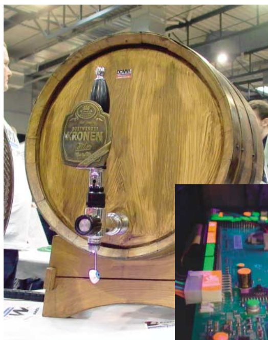
Außen ein Bierfass, innen ein nicht biergekühlter Computer. Sämtliche Elkos sind mit Leuchtfarbe bepinselt, die im UV-Licht fluoresziert.
