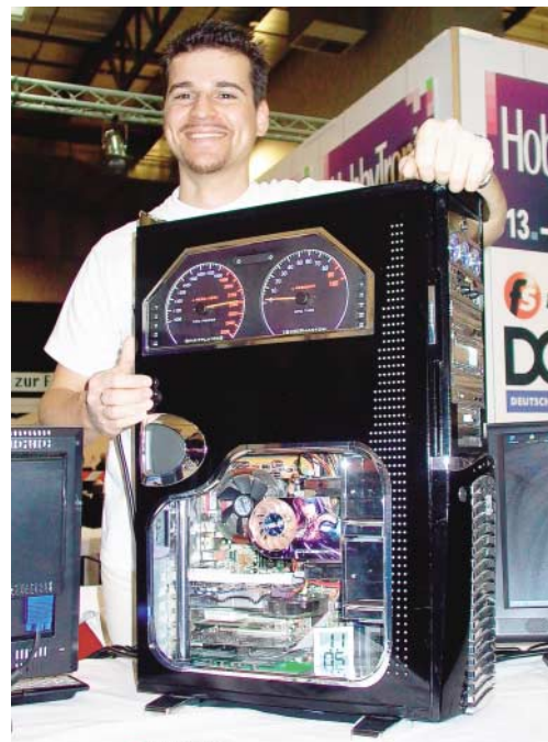
Am Heck Auspuffrohre, die Flammen schlagen, an der Seite zwei umgemodelte Tachometer, die CPU-Takt und -Last anzeigen: Bernd Haberkorns „SPS-Phantom“ ist der dritt-spektakulärste Computer Deutschlands.
