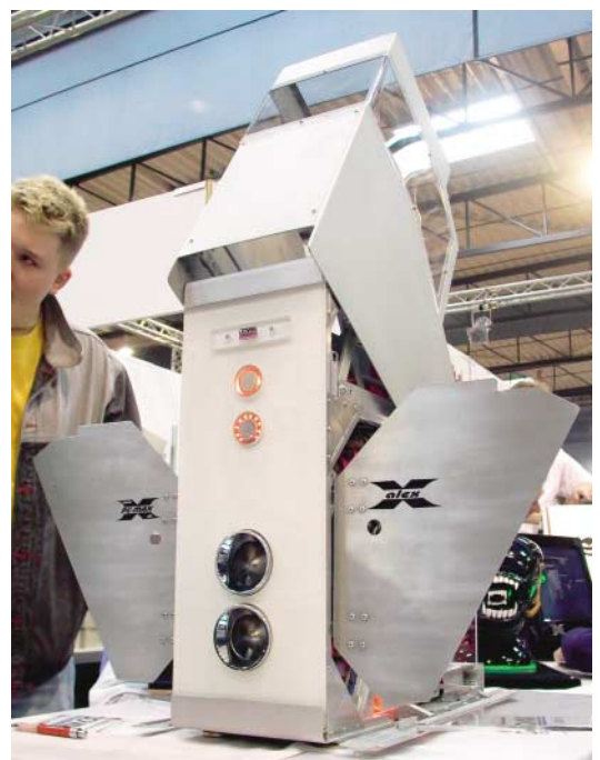
Motorgetriebener Deckel und automatisch ausklappende Seitenwände: Ausgefallene Technik und handwerkliches Können brachten Alexander Sieners „motion X“ auf Platz 2 in der Casecon-Kategorie.
