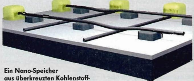
**Ein Nano-Speicher aus überkreuzten Kohlenstoff-Nanoröhren könnte eine Integrationsdichte von bis zu  $10^{12}$  Bits pro Quadratmeter erreichen.**
