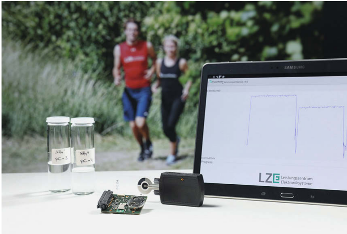
Das Fraunhofer-Institut für Integrierte Schaltungen (IIS) zeigt auf der CeBIT einen Sensor, der körperliche Belastungszustände anhand der Ammoniakkonzentration in Schweiß nachweist.
